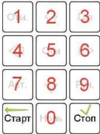
Рисунок 21 – Кнопки ввода пароля на пульте оператора
